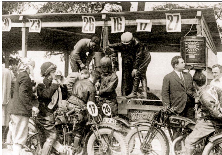
Pánové Vaněk a Zweig v depu II. Velké ceny Československa 30. června 1929. Motocykly jsou tovární speciály Saroléa 23U. Byla to výjimečná omezená série možno říci prototypů z roku 1928, u které se zkoušely moderní prvky pro novou řadu příštích let. Dnes patří mezi sběrateli k nejvyhledávanějším modelům Saroléa. Oba „kolegové“ závod nedokončili. Zweig kvůli poruše náhonu vačky, Vaňkovi selhaly brzdy
